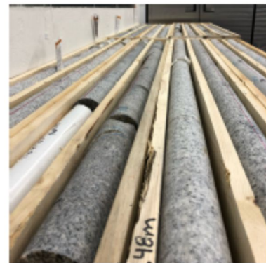
Carottes de forage extraites du socle rocheux dans la région d’Ignace (représentant au total 6 km de roche forée). Elles seront évaluées pour leur capacité ou non de stocker du combustible irradié
